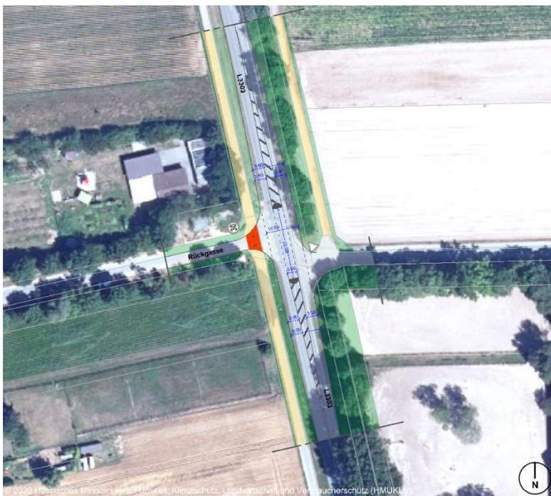
Abbildung 27 L 3303/Rückgasse: Detail Querungshilfe
