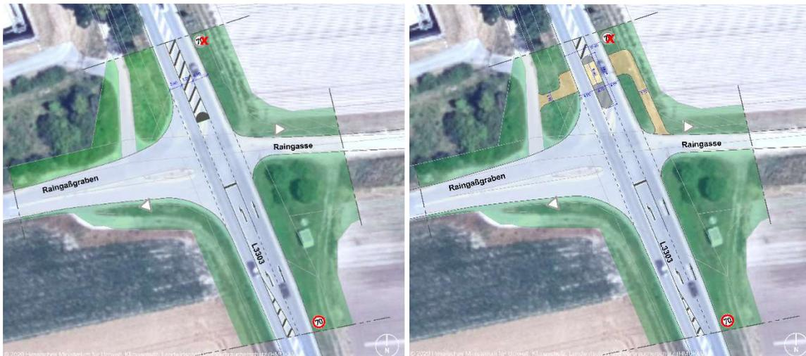
Abbildung 26 Querung L 3303/ Raingasse: gesicherte Aufstellfläche (l), mit Mittelinsel (r)
