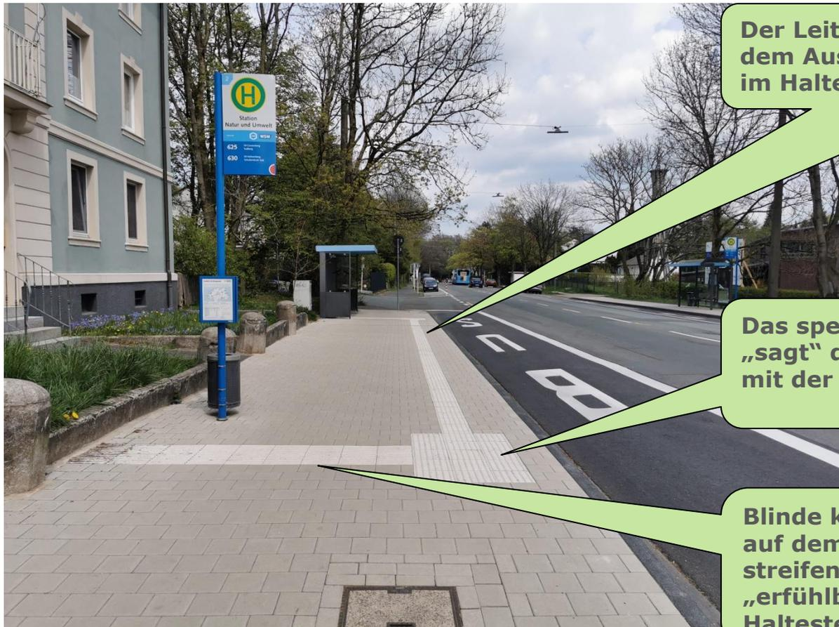
Der Leitstreifen hilft den Blinden nach dem Aussteigen bei der Orientierung im Haltestellenbereich.
