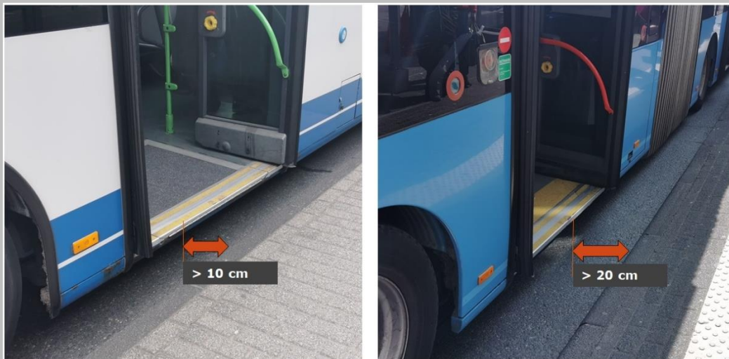
Abbildung 4: Spaltbildung am Einstieg bei nicht optimiertem Ausbau
