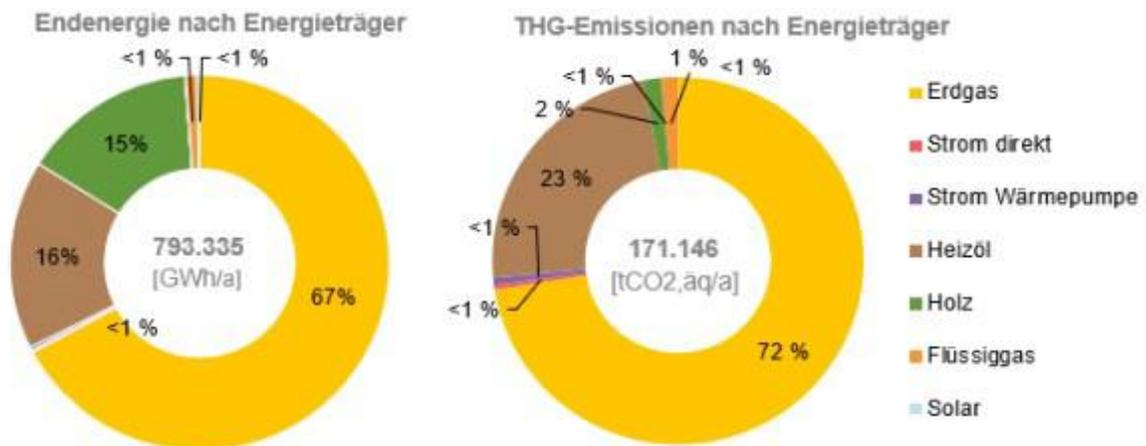
Die größten Anteile an den CO<sub>2</sub>-Emissionen machen mit 95 % die fossilen Energieträger Erdgas und Heizöl aus. Die Fernwärme ist in der dargestellten Grafik auf die für die Wärmeerzeugung eingesetzten Energieträger aufgeteilt. Holz nimmt in der THG-Bilanz einen im Vergleich zur Darstellung der Erzeugernutzwärme deutlich geringeren Anteil ein, da dieses gegenüber den fossilen Energieträgern ökologisch besser bewertet ist.
