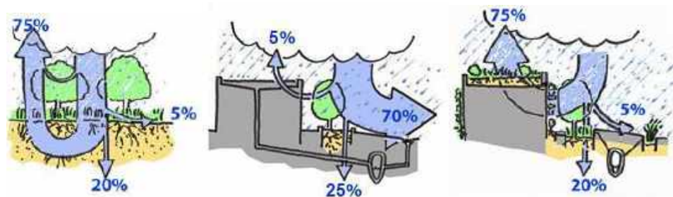
Abbildung 34 - Verdunstung, Versickerung und Oberflächenabfluss in einem natürlichen Wasserkreislauf (links), im Siedlungsgebiet (Mitte) und im Siedlungsgebiet mit nachhaltigem Regenwassermanagement (rechts) (Abbildungen: Stadt Wien, MA 22, Christian Härtel).
