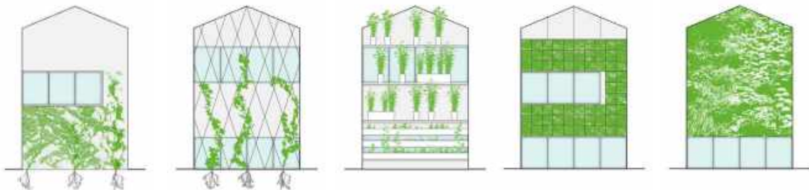
Abbildung 107 - Bodengebundene und wandgebundene Fassadenbegrünung (Abbildungen: Prof. Dr. Nicole Pfoser, HfWU Nürtingen, Kompetenzzentrum für Gebäudebegrünung und Stadtklima e.V.).
