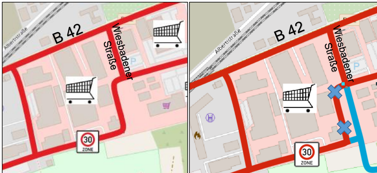
Abbildung 24: Schematische Darstellung der bestehenden und geplanten Verkehrsführung (Quelle: OpenStreetMaps)
