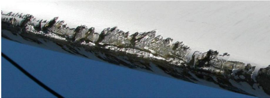
"Die Regen-Erosion ist bereits ein ernstes Problem, das sich mit den längeren Rotorblättern noch verschärft, da sie an ihrer Spitze Geschwindigkeiten von über 380 Stundenkilometern erreichen können. Regentropfen wirken bei dieser Geschwindigkeit wie ein Kugelhagel, der mit der Zeit die Vorderkante des Blattes beschädigt", erklärt Martin Huus Bjerge, CEO von Rope Robotics<sup>2</sup>. Nein aha
